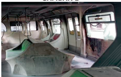
Depoh KL Monorail - Monorel 4 gerabak terbakar berpunca daripada tayar tren meletup (25.11.2021) (Sumber: Jabatan Audit Negara)
