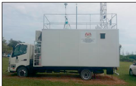
Stesen Pengawasan Kualiti Udara Automatik Bergerak di Serian, Sarawak (Sumber: Portal EQMP, Jabatan Alam Sekitar)
