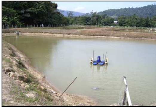
Paddle Wheel Digunakan Untuk Membekal Oksigen Kepada Ternakan Udang
