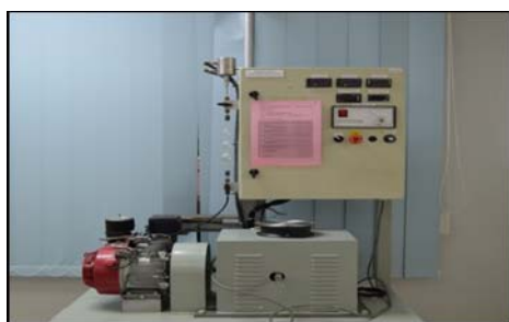
Fluid Mechanics & Thermodynamics Lab, Politeknik Nilai - Ekzos Paip Bagi 1TH3 Single Cylinder Engine Test Bed Tidak Disalurkan Keluar Makmal (03.09.2014)
