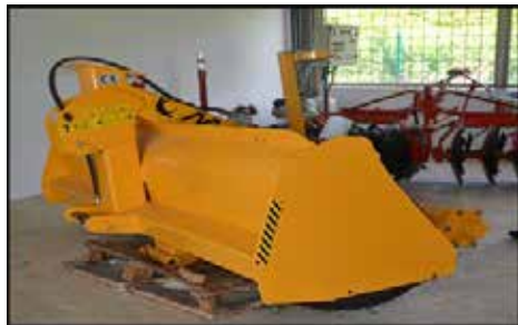
Pusat Ladang, Politeknik Sandakan - YMS 13 Land Levelling Laser Guided Tidak Digunakan Kerana Traktor Tidak Dibekalkan (14.10.2014)
