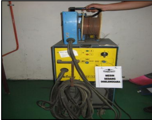
GAMBAR 17.14 Mesin Kimpalan FCAW/GMAW (SAFmig) Yang Rosak Sejak Tahun 2008
