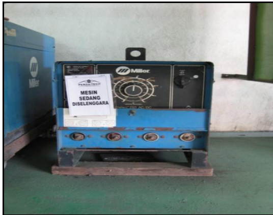
GAMBAR 17.10 Mesin Kimpalan SMAW Yang Rosak Sejak Tahun 2008
