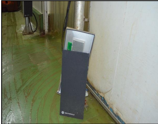
GAMBAR 4.9 Motorola RFID High Performance Antenna Yang Telah Rosak Dan Tidak Digunakan
