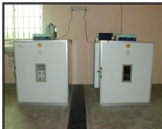
GAMBAR 16.4 Ostrich Setter Dan Ostrich Hatcher Berkapasiti 32 Biji Telur
