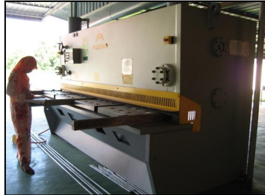
GAMBAR 17.2 Shearing Cutting Machine Yang Diletakkan Di Luar Bengkel
