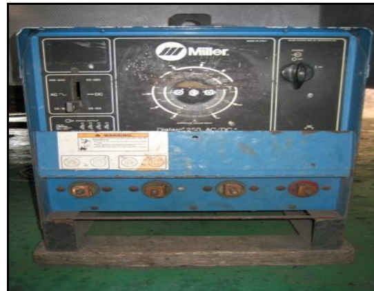
GAMBAR 17.11 Mesin Kimpalan SMAW Yang Rosak Sejak Tahun 2008
