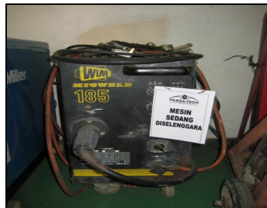
GAMBAR 17.13 Mesin Kimpalan GMAW (WIM MIGWELD 185) Yang Rosak Sejak Tahun 2008
