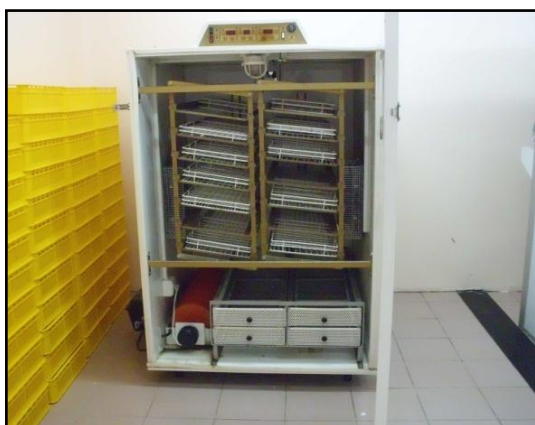
GAMBAR 16.3 Inkubator Berkapasiti 5,000 Biji Telur
