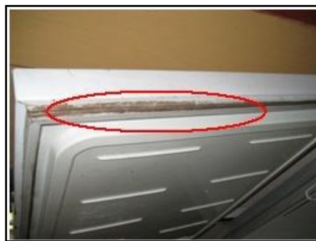
Keadaan Dalam Peti Sejuk Yang Tidak Digunakan Dan Berkulat Di Balai Raya Kampung Bukit Samsu, Kota Tinggi Johor
