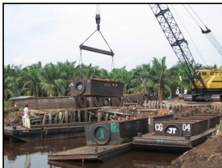
Pengangkutan Air Digunakan Untuk Memindahkan Kelapa Sawit Yang Dikutip Dari Ladang Ke Kilang
