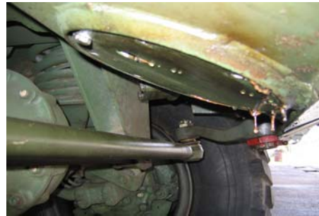
Pasukan 2 Armor Di Raja, Port Dickson, Negeri Sembilan Radpanzer Condor – Tangki Minyak Enjin Bocor
