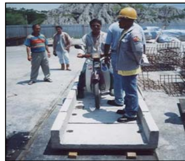
Struktur Precast Slab Bersaiz 1.2 m Mengikut Kontrak
