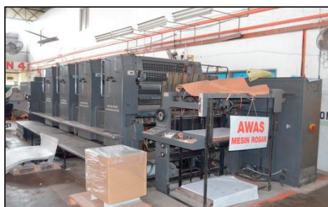
Kilang Percetakan SPYIT - Mesin Cetak Heidelberg SM102-VP(1992) yang Masih Rosak dan Tidak Dapat Digunakan (11.11.2018)
