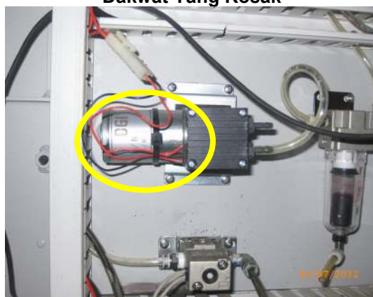
Gambar 6.4 Komponen Mengepam Dakwat Yang Rosak
