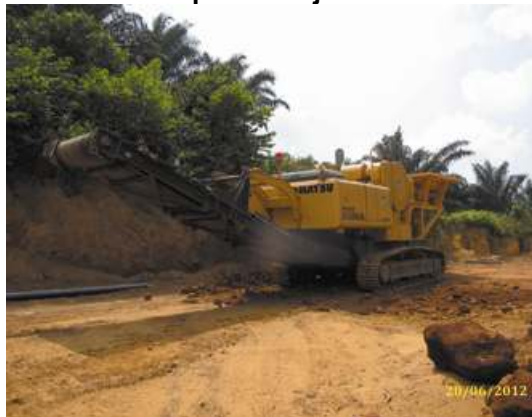
Gambar 5.3 Jentera Yang Digunakan Untuk Memproses Bijih Besi
