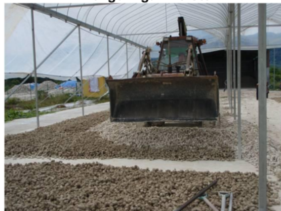
Gambar 4.2 Pemindahan Tanah Liat Dari Kilang Pengeringan Ke Stor
