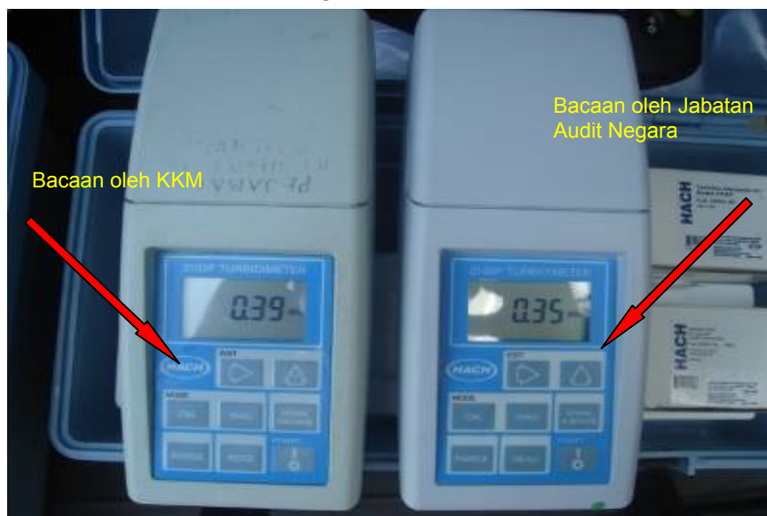
Foto 61 Contoh Bacaan Bagi Parameter Kekeruhan (NTU)
