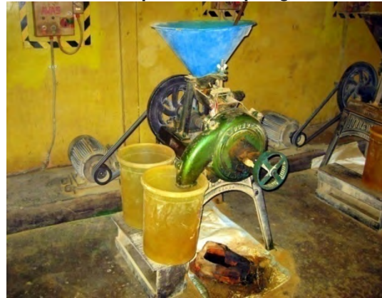
Gambar 2.8 Mesin Yang Digunakan Untuk Mengisar Rempah Dan Tepung
