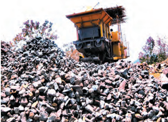
Foto 13.3 Jentera Yang Digunakan Bagi Memecahkan Bongkah Bijih Besi Kepada Saiz Yang Lebih Kecil
