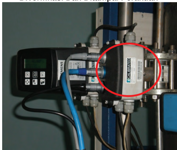
Foto 8.4 Meter Pengeluaran Yang Telah Diverifikasi Dan Ditampal Perakuan
