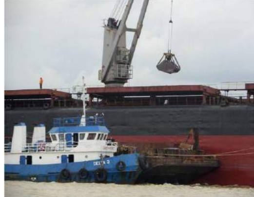
Gambar 3.2 Pemunggahan Arang Batu Dari Tongkang Ke Kapal Induk Sedang Dilakukan
