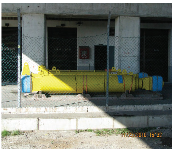
Gambar 10.17 Silinder Hidraulik Telah Dibaik pulih
