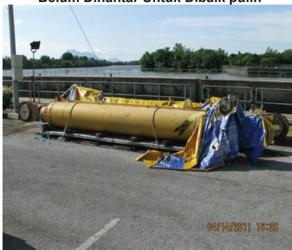
Gambar 10.18 Silinder Hidraulik Terpakai Belum Dihantar Untuk Dibaik pulih
