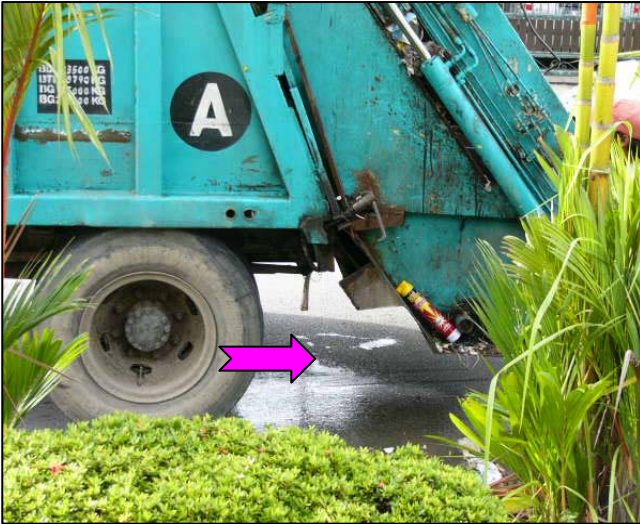
Foto 92 Trak Yang Bocor Dan Air Mengalir Keluar
