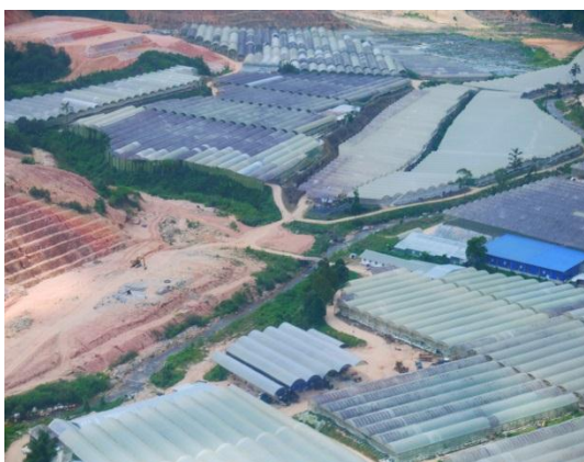
Gambar 3.1 Aktiviti Kerja Tanah Tanpa Pematuhan Pelan Kawalan Hakisan Dan Kelodak (ESCP) Yang Menyumbang Kepada Kekeruhan Air Sungai
