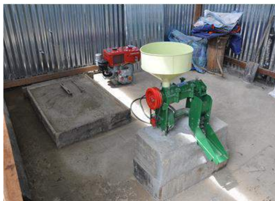
Gambar 2.23 Mesin Pengisar Belum Lengkap Dipasang
