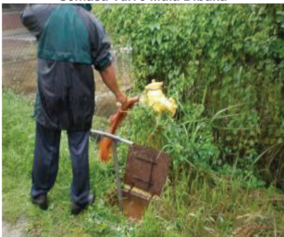
Foto 5.21 Ujian Flushing Di Jajahan Kota Bharu Semasa Valve Mula Dibuka
