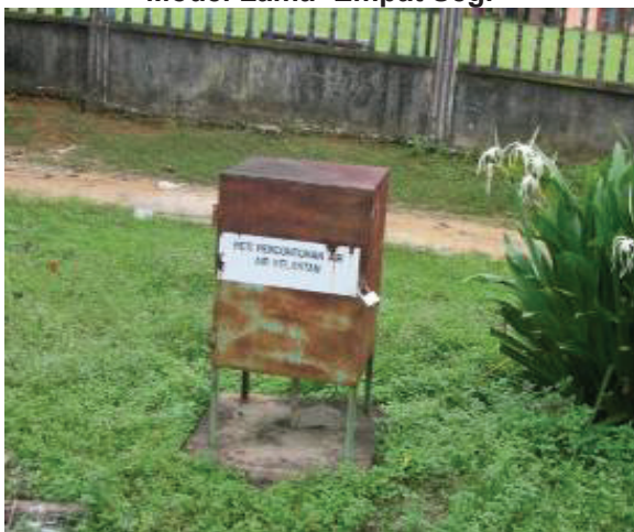
Foto 5.28 Jenis Reka Bentuk Stesen Pensampelan Model Lama- Empat Segi
