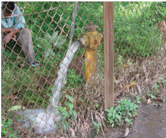
Foto 5.23 Ujian Flushing Di Jajahan Tanah Merah
