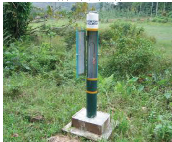
Foto 5.29 Jenis Reka Bentuk Stesen Pensampelan Model Baru -Silinder
