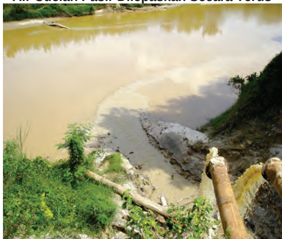
Foto 7.1 Air Cucian Pasir Dilepaskan Secara Terus
