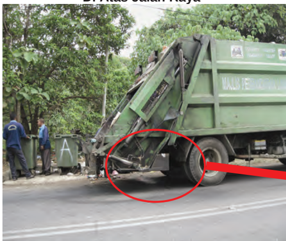
Foto 9.9 Tumpahan Air Larut Resap Di Atas Jalan Raya
