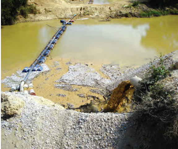
Foto 7.2 Air Cucian Pasir Dilepaskan Secara Terus
