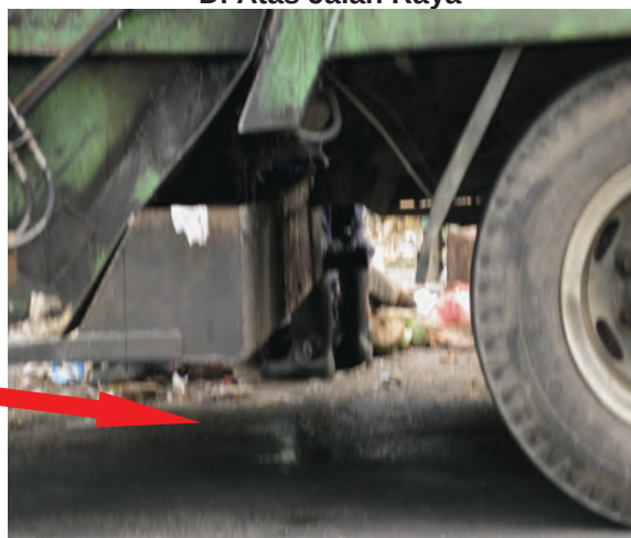
Foto 9.10 Tumpahan Air Larut Resap Di Atas Jalan Raya
