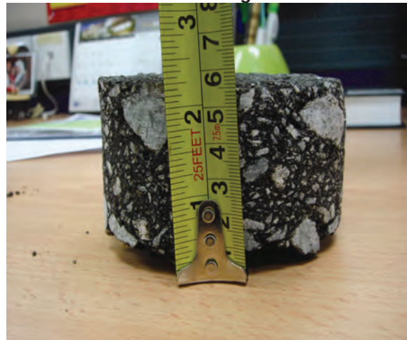
Foto 3.22 Keputusan Ujian Coring bagi Jalan Pendang/ Jenun/Bongor
