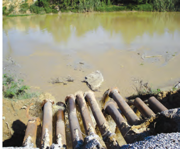
Foto 7.3 Air Cucian Pasir Dilepaskan Secara Terus
