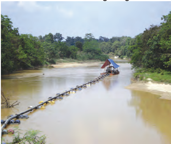
Foto 7.12 Pam Beroperasi Berdekatan Tebing Sungai
