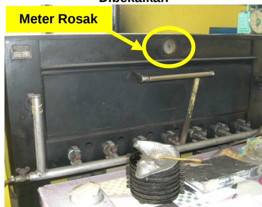
Gambar 9.6 Meter Suhu Oven Yang Diterima Pada Tahun 2006 Rosak Selepas Setahun Dibekalkan
