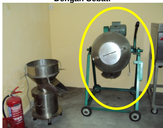
Gambar 9.3 Mesin Tidak Dapat Menggaul Tepung Dengan Sebati
