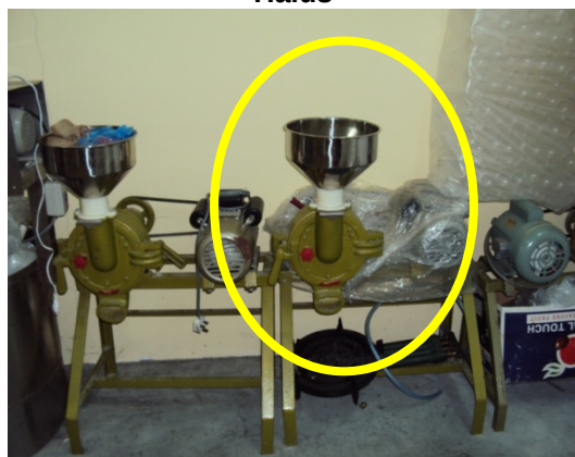
Gambar 9.2 Mesin Tidak Dapat Mengisar Cili Dengan Halus
