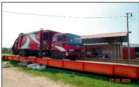
Tapak Pelupusan Beris Lalang, Bachok - Lori masuk berada di atas jambatan timbang (24.05.2023) (Sumber: KUMHSB)
