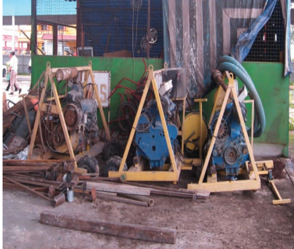
Foto 7.21 Mesin Penyembur Air Bertekanan Tinggi Rosak
