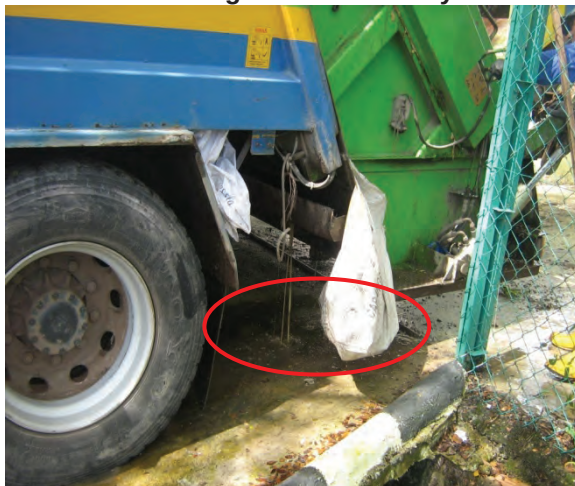
Foto 7.1 Air Kurasan Keluar Dari Lori Kompaktor Dan Mengalir Ke Jalan Raya
