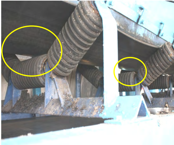
Gambar 6.19 Getah Conveyor Yang Tidak Bersentuhan Dengan Roller
